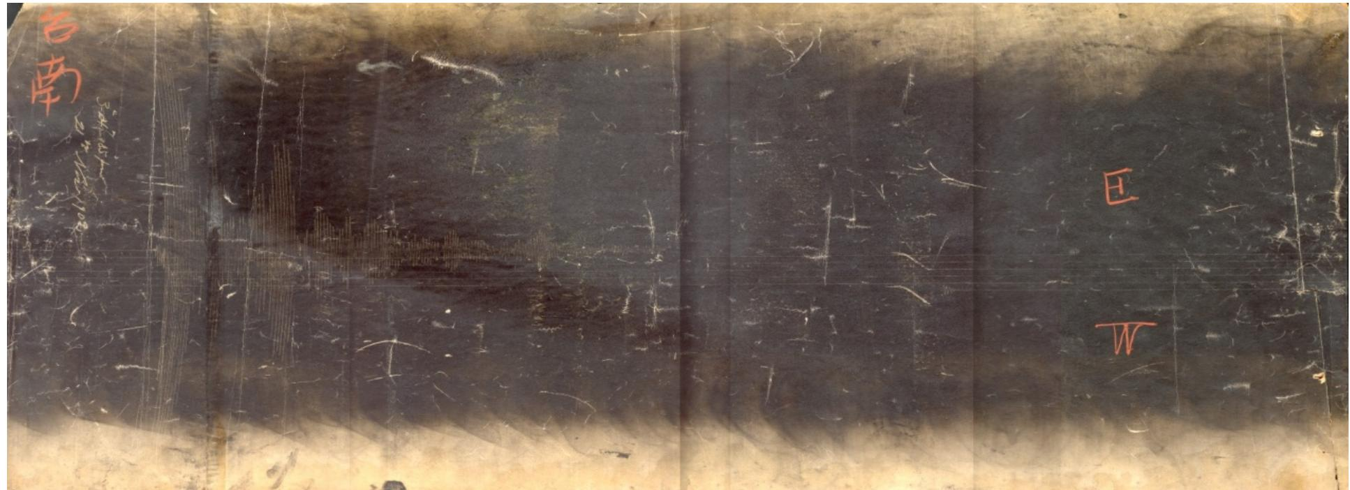
台南測候所Omori地震儀收錄1902/11/21地震( $21.8^{\circ}\text{N}$ ,  $120.7^{\circ}\text{E}$ , Dep=10km,  $M_L=6.7$ ,  $M_W=6.9$ ,  $M_S=6.8$ )波形(6倍, 週期12秒)(紀錄紙 75 cm x 30 cm)
